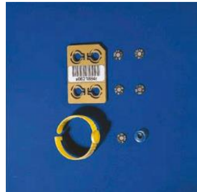
شکل ۱. چیپ‌های TLD-100(Lif:Mg,Ti) که در قالب بچ و حلقه به کار می‌رود.
